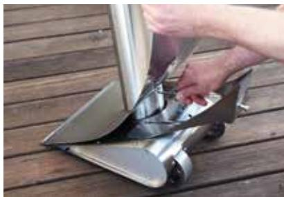
3. Incline la vela con el tubo levemente hacia adelante hasta que la barra de la rejilla de ceniza sobresalga de su soporte unos 10 cm. Gire la barra 90° para que la ceniza caiga en el cenicero.
